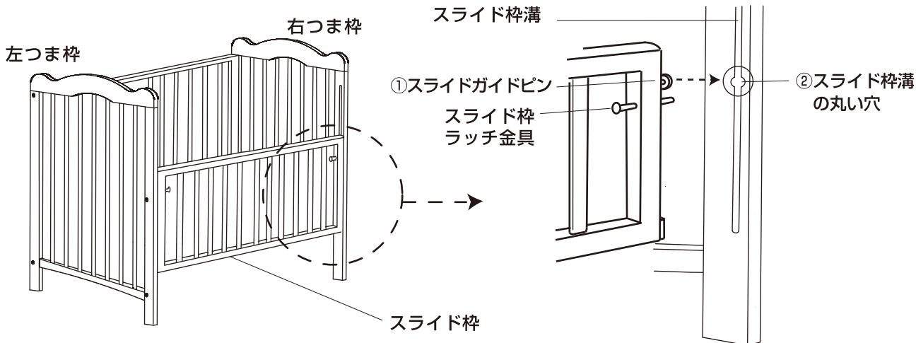
⚠ スライド枠溝の丸い穴に必ず位置を合わせ、スライド枠を左右平行に保ったまま上にスライドさせてください。丸い部分の位置がずれていったり、スライド枠が斜めに傾いた状態で無理に動かすと、スライド枠溝が割れる原因になります。
