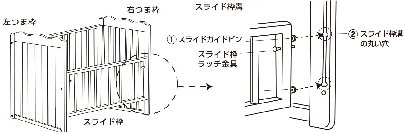
⚠ スライド枠溝の丸い穴に必ず位置を合わせ、スライド枠を左右平行に保ったまま上にスライドさせてください。丸い部分の位置がずれていれば、スライド枠が斜めに傾いた状態で無理に動かすと、スライド枠溝が割れる原因になります。
