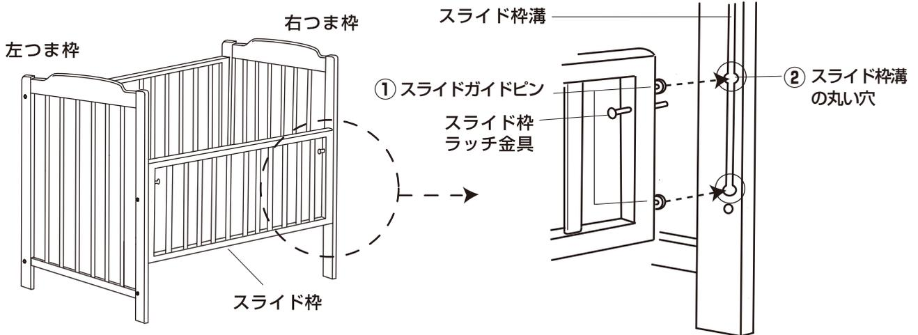
⚠ スライド枠溝の丸い穴に必ず位置を合わせ、スライド枠を左右平行に保ったまま上にスライドさせてください。丸い部分の位置がずれていたり、スライド枠が斜めに傾いた状態で無理に動かすと、スライド枠溝が割れる原因になります。
