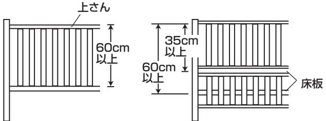
**⑥** 床板は、使用時に容易にはずれないようしつかりとした構造になっています。
