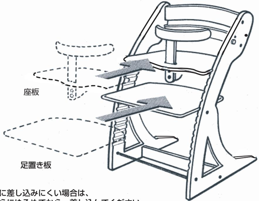
※座板・足置き板が溝に差し込みにくい場合は、組み立てボルトをさらにゆるめてから、差し込んでください。
