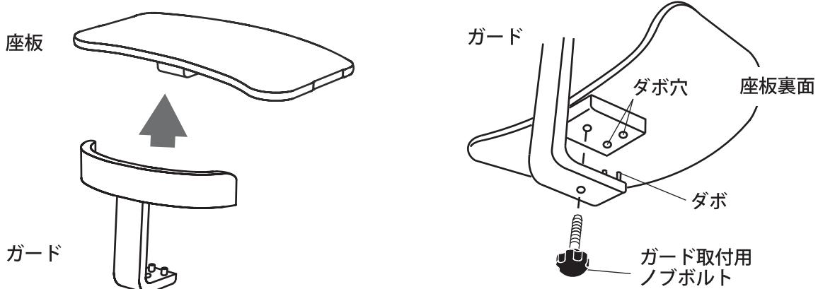
※ 取り付け・取り外しの際はダボ穴に対し、まっすぐに抜き差ししてください。
