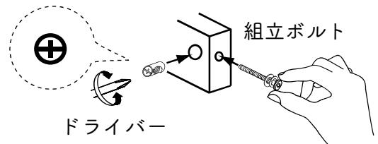
⚠ ボルトが丸ナットに、はまらない時は一度ボルトをゆるめ、再びボルトをナットの穴に対して、まっすぐに入れて手でゆっくりと締めなおしてください。
