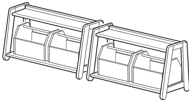
六角レンチで連結用ボルトを外し、上下フレームの連結を外します。
