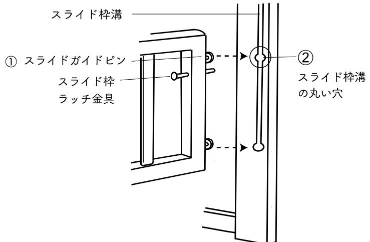
⚠ スライド枠溝の丸い穴に必ず位置を合わせ、スライド枠を左右平行に保ったまま上にスライドさせてください。丸い部分の位置がずれていれば、スライド枠が斜めに傾いた状態で無理に動かすと、スライド枠溝が割れる原因になります。
