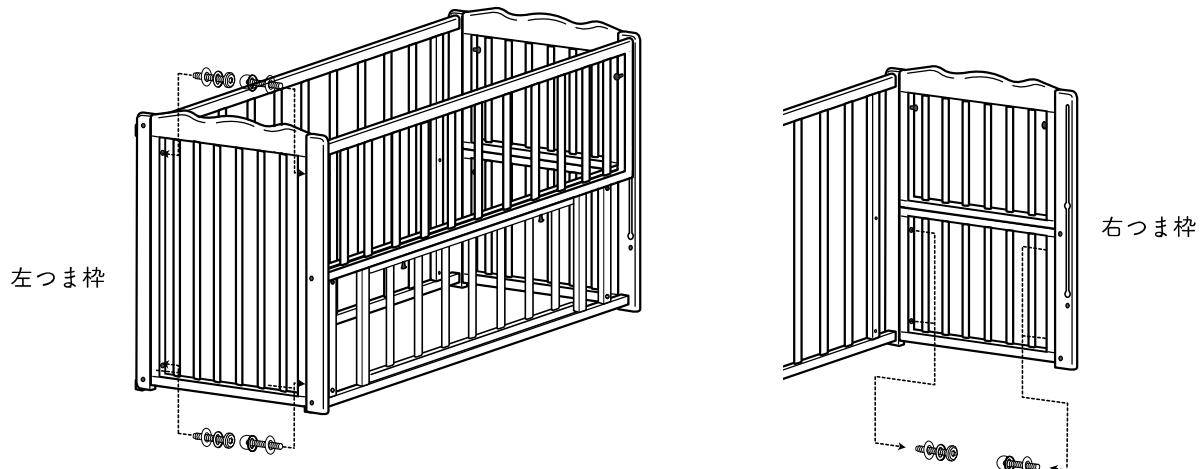
左右フレームを入れ替えて再度ボルトにて固定したら付け替え完了です。
